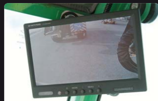
Caméra vidéo avec moniteur pour vision arrière du bras Cámara de vídeo con monitor para visual trasera del brazo
